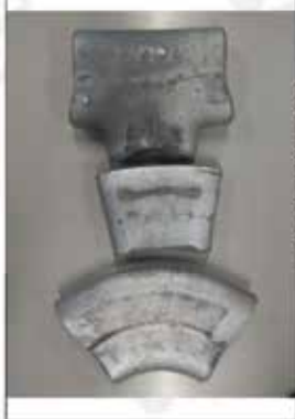
照片 E: 測試後 (抗壓試驗)
