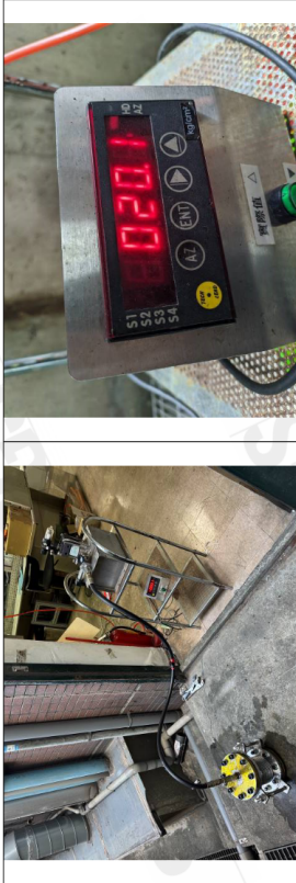
照片 C: 測試架設 (耐水壓測試)
